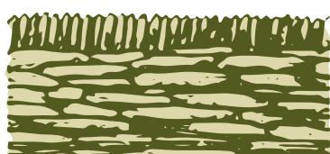
Constrúense con muros de laxe superpostas horizontalmente en seco
